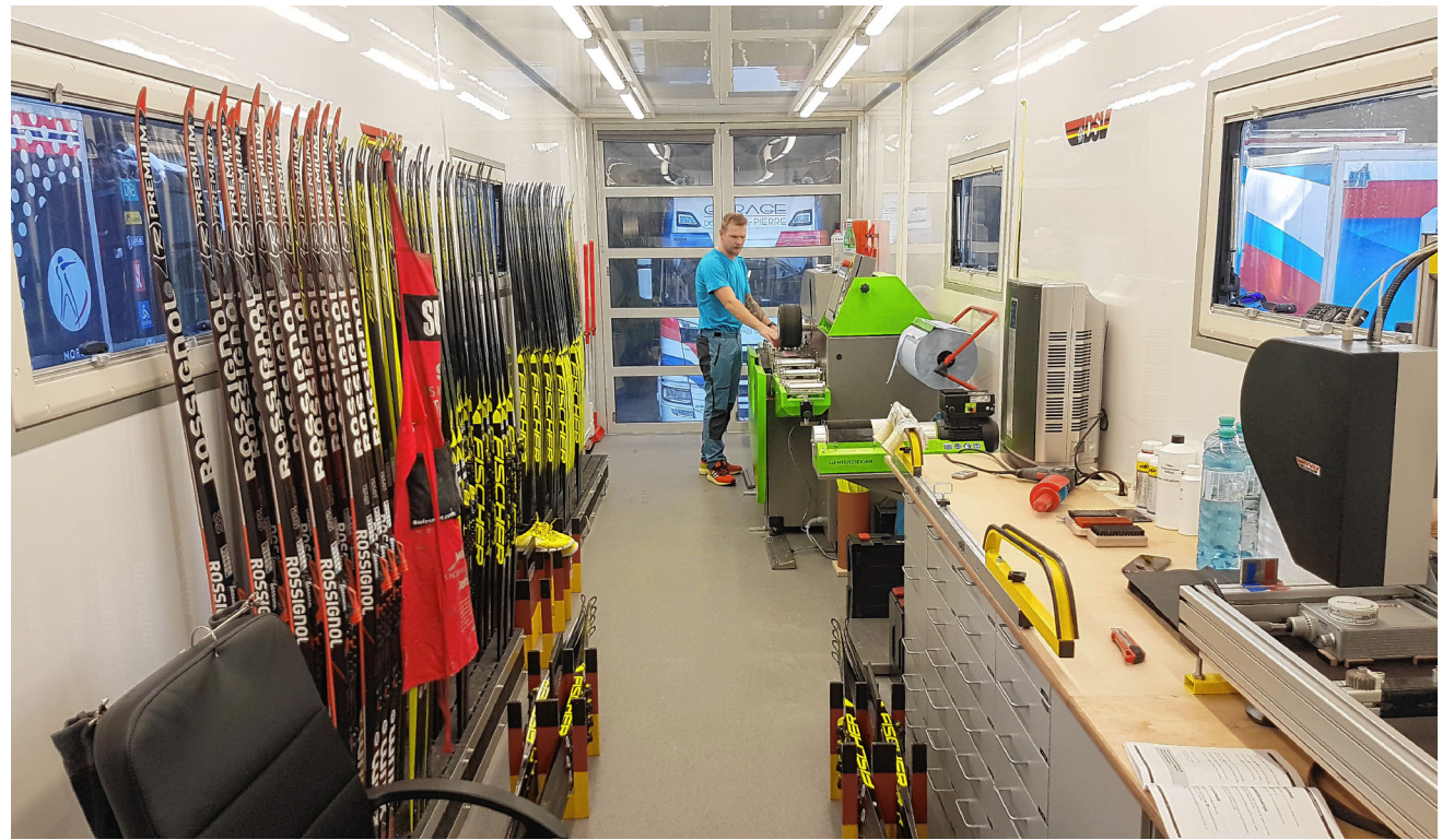
Die Skitechniker des Deutschen Skiverbands bauen vor den Wettkämpfen eine mobile Schleifwerkstatt auf, in der Skier optimal präpariert werden. Eine gute Vorbereitung leistet einen wichtigen Beitrag zum sportlichen Erfolg. BILD: ENRICO HEISIG
